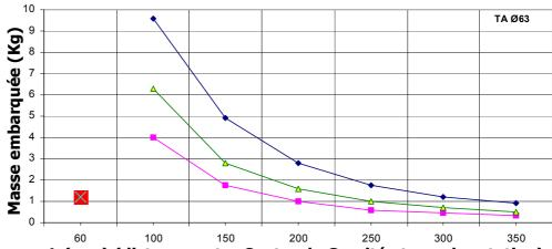
L (mm) (distance entre Centre de Gravité et axe de rotation)
